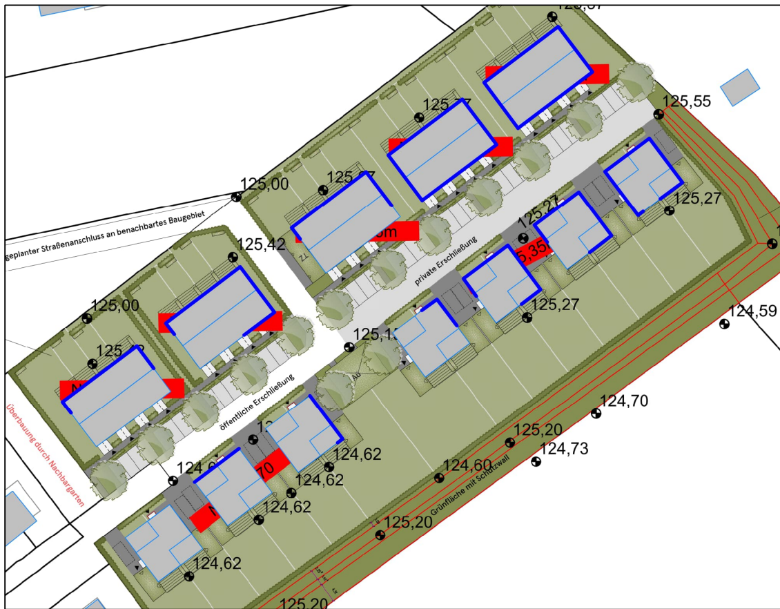
Abbildung 4: Lageplan mit Kennzeichnung der Fassadenbereiche, an denen Immissionsgrenzwertüberschreitungen zur Nachtzeit prognostiziert werden
